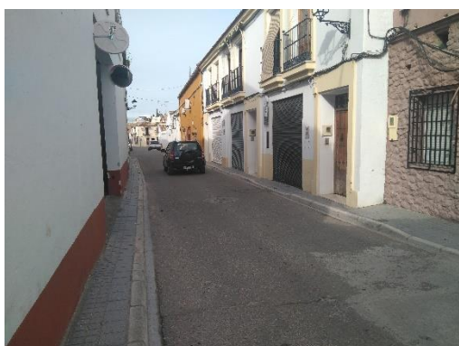
c. Rioseco. Tramo de paso regulado de vehículos por fase semafórica alternativa con aceras insuficientes que obligan al peatón a circular por la calzada.
